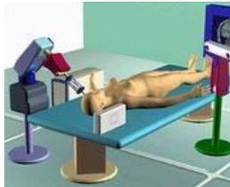
Il progetto **ROBOCAST** ha permesso di elaborare un nuovo tipo di robot che offre due importanti vantaggi per i chirurghi: 13 gradi (tipi) di movimento, rispetto ai 4 consentiti dalle mani umane durante interventi di chirurgia mini-invasiva e il **"feedback tattile"**, ossia i segnali fisici che permettono ai chirurghi di valutare i tessuti e percepire la quantità di forza applicata durante l'intervento.
